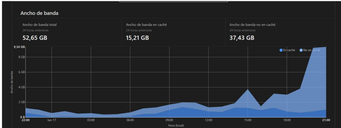
La anterior imagen muestra un resumen del ancho de banda que se generó durante las pruebas del ataque DoS dando como resultado un total de 52.65GB de tráfico generado, con un pico máximo de 9.36 GB, 15.21GB de ancho de banda en cache.
